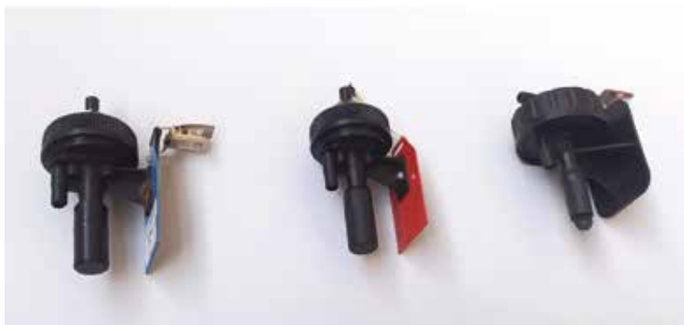
Fig.3 Ciclones similares, del tipo Higgins and Dewell (HD)
